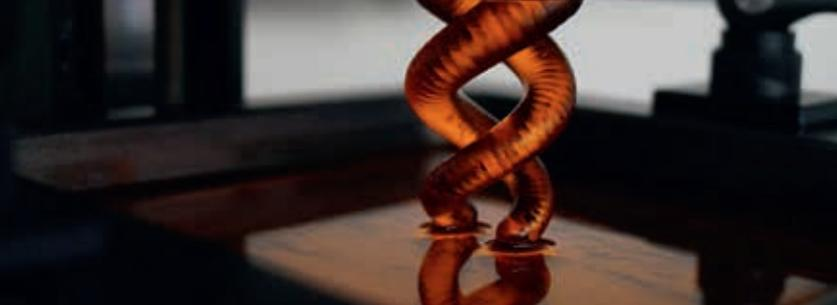
3-D-Druck einer schichtweise entstehenden Doppelhelix aus flüssigem Acrylharz, die mittels Belichtung an einer Bauplattform aushärtet. Foto: Anne Asmacher/FMF
